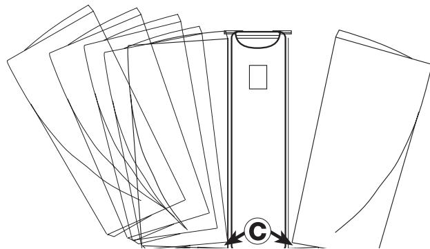
1. Heben Sie die Sicherheitsverriegelung leicht mit dem Finger an. Wenn die Sicherheitsverriegelung gelöst ist, heben Sie die Hauptverriegelung an, um den Lautsprecher abzunehmen.
