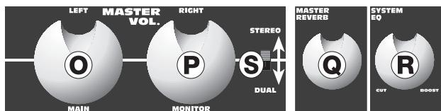
**O & P. MASTER VOLUME LEVEL CONTROL** - 左右のマスター・ボリューム・コントロールで、PD-250の出力音量を調整します。マスター・コントロールは、クリック付きの位置表示を備えています。パスポート・システムの操作のほとんどは、これらのコントロールを12時のクリック位置に設定した状態で操作するように調整されています。より大きな音量が必要な場合には、マスター・コントロールを中央の位置から右へ回すと、レベルを6dB上げることができます。
