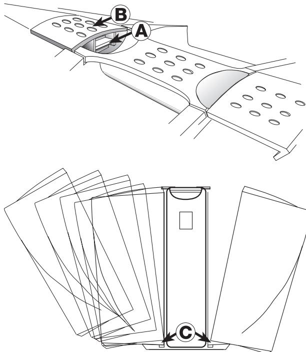
1. セーフティ・ラッチの下に指先をかけて、ゆっくり引き起こします。セーフティ・ラッチがはずれたら、メイン・ラッチを引き起こしてスピーカをはずします。
