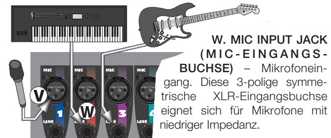
**W. MIC INPUT JACK (MIC-EINGANGSBUCHSE)** – Mikrofoneingang. Diese 3-polige symmetrische XLR-Eingangsbuchse eignet sich für Mikrofone mit niedriger Impedanz.
