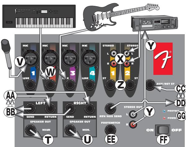
**X& Z. STEREO INPUT** - ステレオ・フォノ (RCA) 入力ジャックと、1/4インチTRSジャック（先端部=左チャンネル、リング部=右チャンネル、スリーブ部=グランド）と配線されています。これは市販ケーブルの標準規格です）は、テープ・プレイヤー、CDプレイヤーその他のステレオ・ソースを使用するために設計されています。これらのジャックを使用して、コンピュータ・サウンド・カードや類似したデバイスの出力をパスポートに接続します。1/8インチ・オス・プラグをRCAオス・フォノ・プラグに変換するアダプタは、電器店で簡単に購入できます。注：これらのコネクタは常に「ライン・レベル」に設定されています。
