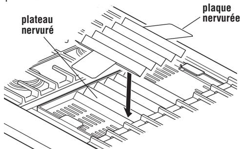
**H.** Placer la plaque nervurée sur le plateau nervuré tel qu'illustré. La plaque nervurée doit être centrée sur le plateau nervuré.
