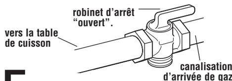
**F.** La canalisation d'arrivée de gaz devra comporter un robinet d'arrêt homologué. Ce robinet d'arrêt devra être situé dans la même pièce que la table de cuisson, à un emplacement permettant un accès aisé pour les manoeuvres d'ouverture et de fermeture. Ne pas entraver l'accès au robinet d'arrêt; celui-ci est utilisé pour ouvrir et interrompre l'alimentation en gaz de l'appareil.
