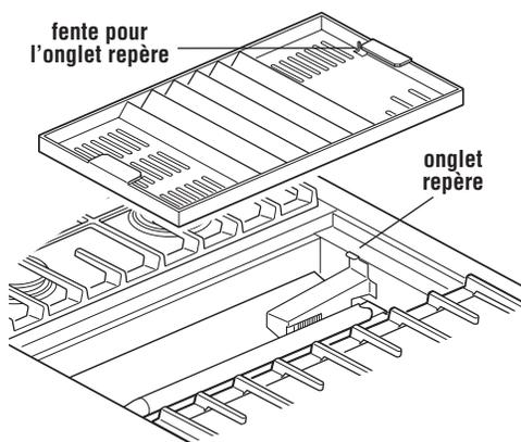
**G.** Installer le plateau nervuré dans la cavité du gril ou de la plaque à frire. L'onglet dans le coin arrière gauche de la cavité doit passer à travers la fente dans le coin arrière gauche du plateau nervuré.
