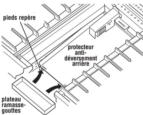
**B.** Placer le protecteur anti-déversement au fond de la cavité du gril et glisser le plateau vers l'avant de telle sorte qu'il se trouve en position transversale contre les pieds repère du protecteur anti-déversement arrière.
