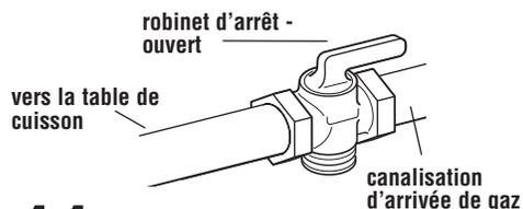
**11.** Ouvrir le robinet d'arrêt de la canalisation de gaz. Attendre pendant quelques minutes que le gaz remplisse la canalisation.
