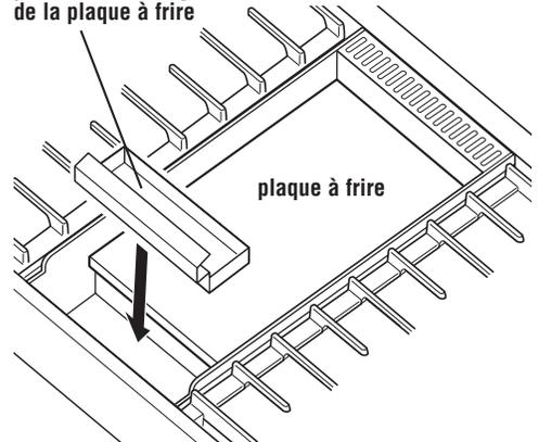
**A.** Placer le plateau ramasse-gouttes dans les puits à l'avant de la plaque à frire. Glisser le plateau vers l'avant jusqu'à l'arrêt.
