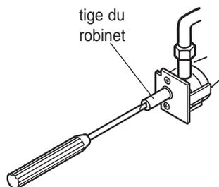
**B.** Ajustement de la flamme des brûleurs de surface ou du gril : Remarque : La flamme de la plaque à frire n'est pas ajustable. Le débit de gaz est à 100 % et la température est contrôlée par thermostat.
