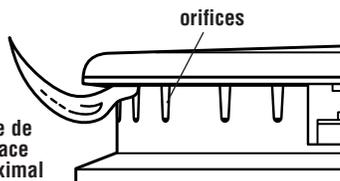
**C.** Vérifier qu'au réglage "HI" la flamme est de couleur bleue. Elle devrait être nette et d'apparence douce. La flamme ne devrait pas comporter de pointe jaune, ni émettre des flammèches ou se détacher. Les éclats orange occasionnels sont normaux et reflètent différents éléments dans l'air ou le gaz.
