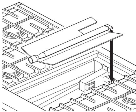
**D.** Réinstaller le brûleur. S'assurer que le rebord arrière des brûleurs repose dans la fente.
