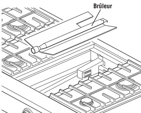
**A.** Soulever le brûleur hors de la cavité et le mettre de côté.
