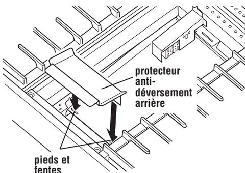
**C.** Insérer les pieds du protecteur anti-déversement avant dans les fentes du protecteur anti-déversement arrière. Le rebord arrière reposera sur le coffret des brûleurs.
