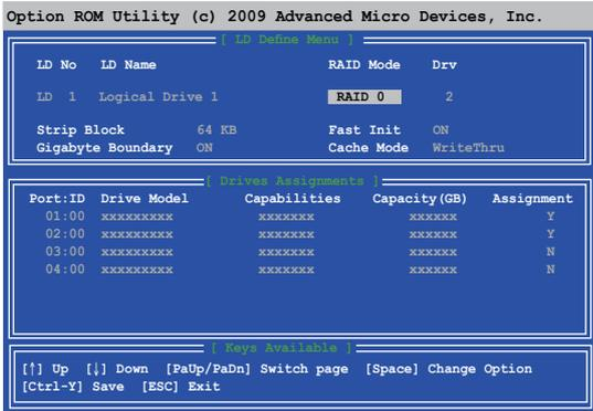
3. Gehen Sie zum Element **RAID Mode** und drücken Sie die <Leertaste>, um den gewünschten RAID-Modus einzurichten.
