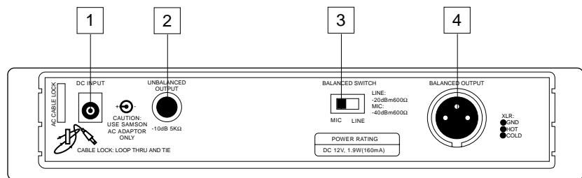
**1: Connecteur d'alimentation** - Connectez à cet endroit l'adaptateur 12 volts-160 mA fourni, avec le clip de maintien en vous référant à l'illustration (ci-dessous). **ATTENTION :** n'utilisez aucun autre type d'adaptateur, au risque d'endommager sérieusement votre récepteur UR1 et de voir votre garantie annulée.
