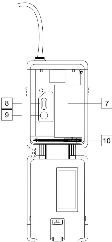
**7: Receptáculo de la pila** - Coloque aquí una pila alcalina de 9 voltios standard, asegurándose de seguir las indicaciones de colocación de los polos positivo y negativo. Recomendamos las pilas del tipo Duracell MN 1604. Aunque se pueden usar también pilas recargables de níquel-cadmio, estas no dan una corriente adecuada durante más de cuatro horas. **ATENCIÓN:** No coloque la pila al revés; el hacerlo puede producir daños graves en el UT1L / UT1G y anularía la garantía.
