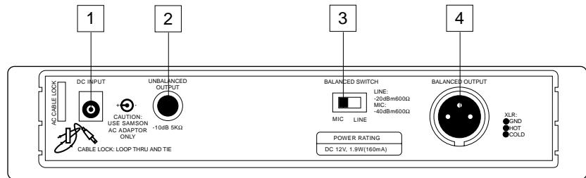
**1: Anschluß für das Netzteil** - Schließen Sie hier das beiliegende Netzteil wie unten dargestellt an. ACHTUNG: Verwenden Sie niemals ein anderes als das beiliegende Netzgerät, da ansonsten der UR1 beschädigt werden könnte und Ihre Garantie erlischt.
