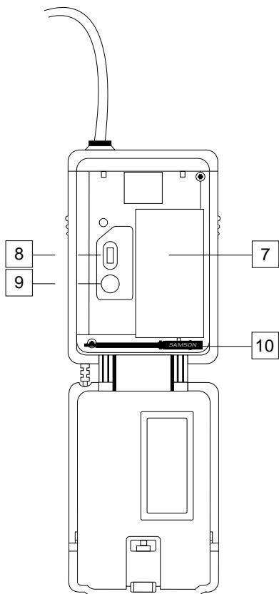
**7: Compartiment de la pile** - Insérez une pile alcaline standard de 9 volts en veillant à respecter les polarités positive et négative indiquées par les repères. Nous recommandons le modèle Duracell MN 1604. Bien que les piles rechargeables au Cad-Ni puissent être utilisées, elles ne fournissent pas une puissance suffisante au-delà de quatre heures. **ATTENTION :** Ne pas insérer la pile à l'envers ; cela pourrait endommager sérieusement les émetteurs UT1L /UT1G et annulerait votre garantie.
