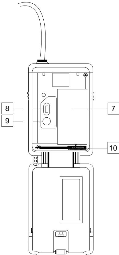
**7: Batteriefach** - Legen Sie hier eine normale 9-V-Batterie ein. Beachten Sie beim Einlegen die Polarität der Batterie (+ und -). Sie können zwar wiederaufladbare Batterien (Akkus) verwenden, allerdings reduziert sich dann die maximale Betriebszeit auf nicht mehr als vier Stunden. **ACHTUNG:** Legen Sie die Batterien niemals umgedreht in den Sender ein, da ansonsten der UT1L/UT1G beschädigt werden könnte und Ihre Garantie erlischt.
