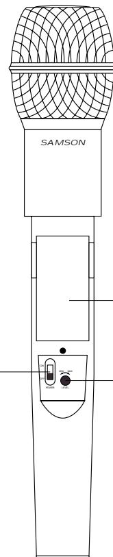
\* Assurez-vous d'avoir coupé le signal audio au niveau du mixeur externe ou de l'amplificateur, avant de mettre l'émetteur sous/hors-tension ; à défaut un "pop" pourrait être audible.
