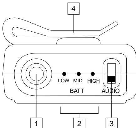
**1: Audioeingang** - Schließen Sie hier die Signalquelle an. Der UT1L wird entweder mit Kopfbügel- oder Ansteckmikrofon ausgeliefert, welches über den Mini-XLR-Anschluß mit dem Sender verbunden wird. Der UT1G dagegen verfügt über ein fest angeschlossenes Kabel mit Klinkenbuchse (6,35 mm).
