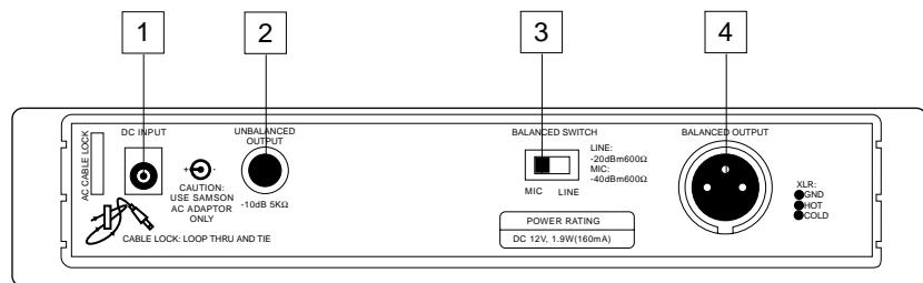
**1: Entrada DC** - Conecte aquí el adaptador de corriente de 12 voltios y 160 mA que se incluye, utilizando la pestaña anti-tirones tal como se ve en la ilustración de abajo.
