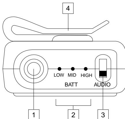
**1: Conector de entrada** - Aquí se conecta la unidad de entrada. El UT1L viene con un micrófono lavalier o de diadema (conectado a través de una toma Switchcraft mini-XLR), mientras que el UT1G viene con un conector de 1/4" permanente.
