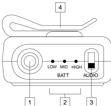
**1: Connecteur d'entrée** - C'est ici que vous connectez le signal d'entrée. L'émetteur UT1L est fourni soit avec un micro cravate, soit avec un ensemble micro-casque (connecté à un mini-connecteur XLR Switchcraft). L'émetteur UT1G est équipé d'un câble jack 6,35 mm rattaché en permanence.
