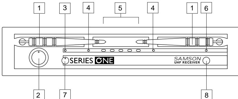
**1: Antennen (A und B)** - Die Antennenhalter haben einen Drehradius von 360°, um eine optimale Aufstellung zu erlauben. Bei normalem Betrieb sollten die beiden Antennen A (links) und B (rechts) senkrecht aufgestellt werden. Die Antennen lassen sich zum Transport des UR1 einschieben. Weitere Informationen über Aufstellung und Betrieb der Antennen erhalten Sie unter der Überschrift „ in dieser Anleitung.
