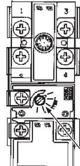
ADJUSTABLE UPPER THERMOSTAT BEHIND UPPER ACCESS PANEL (DUAL ELEMENT MODELS ONLY)
