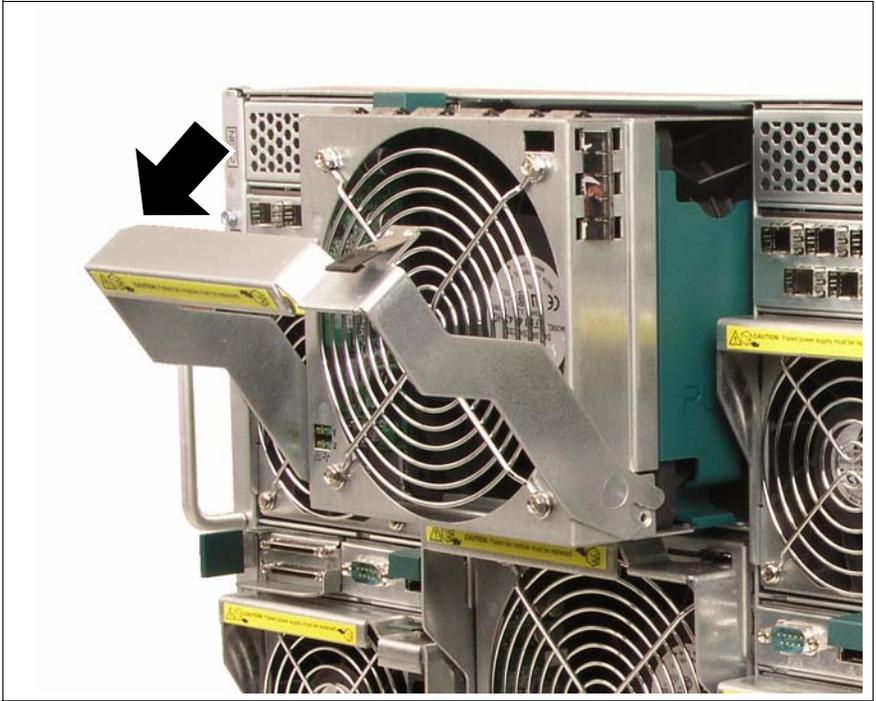
Figure 84: Removing the fan unit
