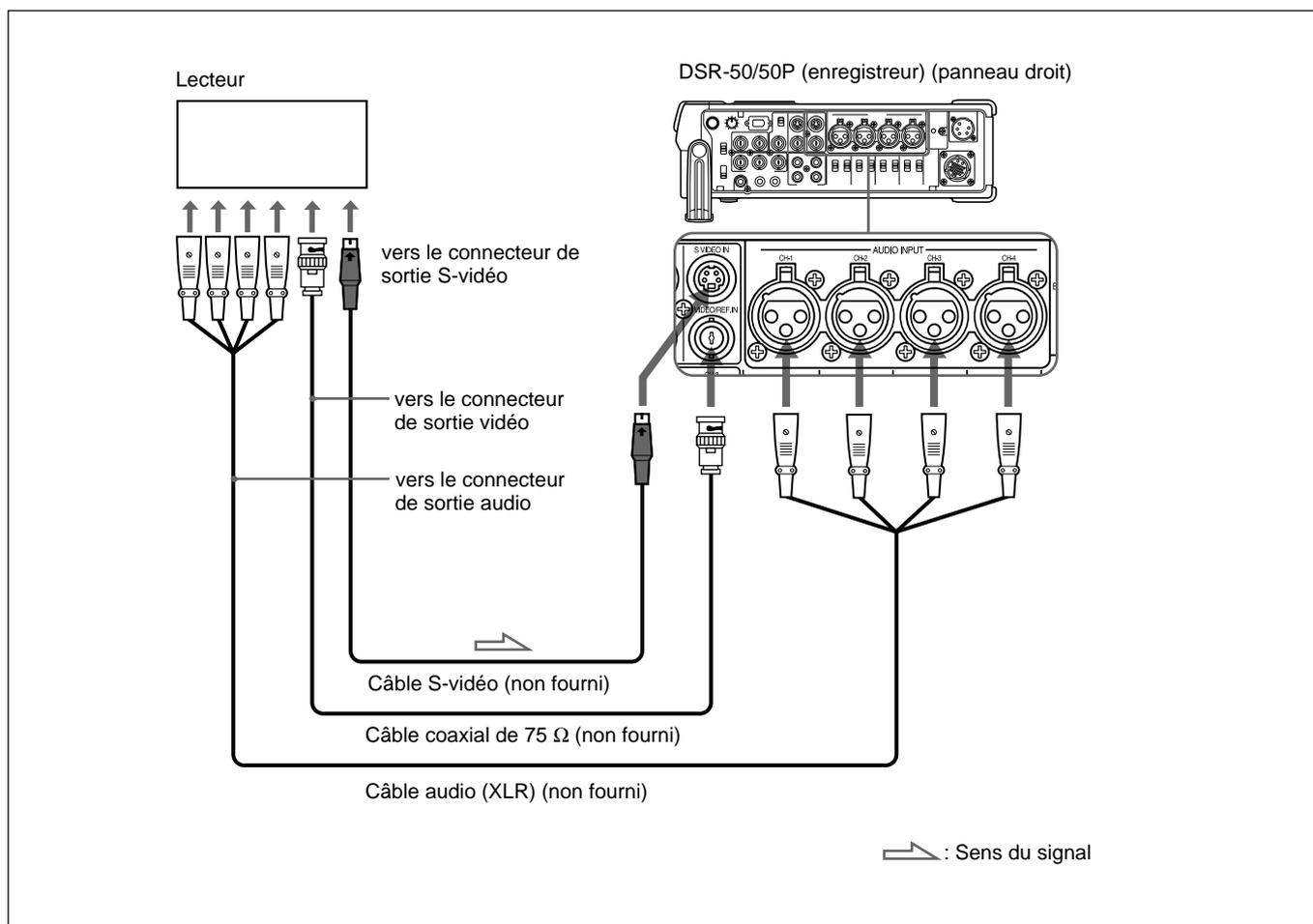
Connectez un des câbles suivants comme câble vidéo ; câble S-vidéo ou coaxial 75 Ω.
