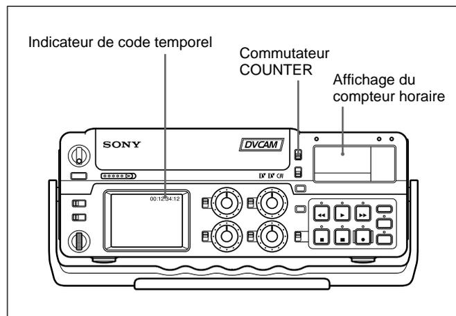
Utilisez le commutateur COUNTER pour sélectionner le type de données de temps à afficher.
