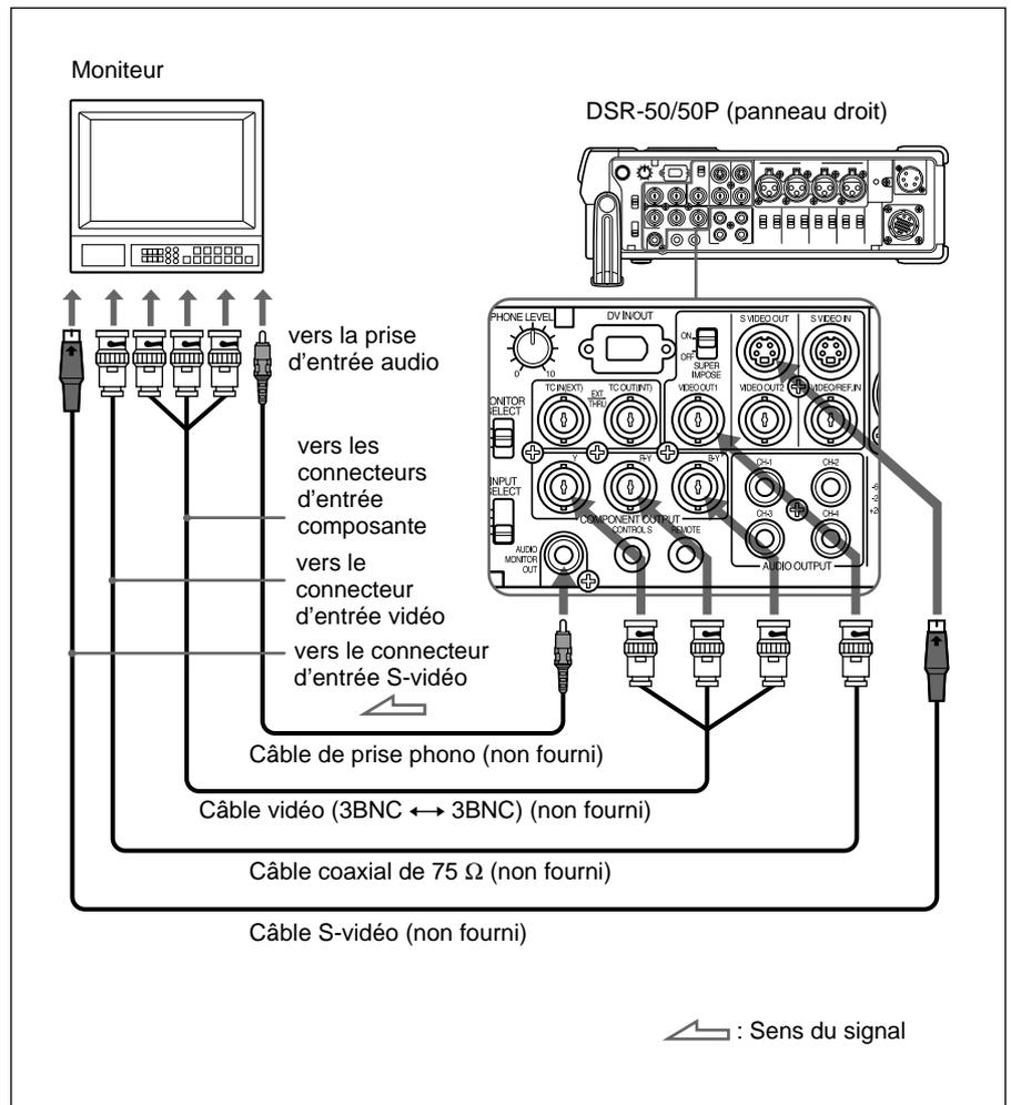
Connectez un des câbles suivants comme câble vidéo ; câble vidéo (3BNC ↔ 3BNC), coaxial 75 Ω ou S-vidéo.
