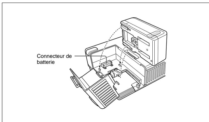
**3** Insérez la batterie BP-L40(A)/L60A/L90A de sorte que le connecteur s'enclenche dans le connecteur de l'unité. Continuez à faire glisser la batterie BP-L40(A)/L60A/L90A jusqu'à ce qu'elle se verrouille en place.
