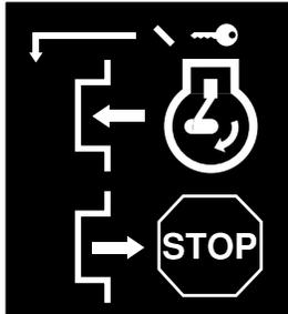
**IGNITION KEY. INSERT TO START AND RUN, PULL OUT TO STOP.**
