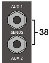
Die Kanalzüge AUX 1 / AUX 2 können beliebig zum Monitoring oder als zusätzliche FX Sends (bei gedrückter AUX 1/2 POST Taste) betrieben werden. Zusätzlich sind AUX 1 bzw. AUX 2 auf den Kanälen USB 3 bzw. USB 4 des DIGITAL AUDIO INTERFACE verfügbar.
