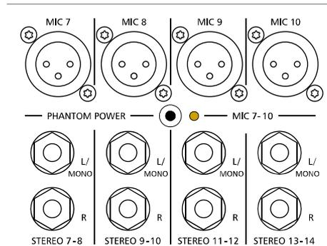
Abbildung 2-9: Belegung der XLR-Mikrofon-Eingänge
