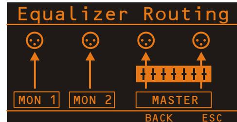
Im Equalizer Routing Dialog kann durch Drehen des MENU/ENTER-Drehencoders die Zuordnung des Graphic Equalizers gewählt werden. Drücken des MENU/ENTER-Drehencoders übernimmt die gewählte Einstellung. Drücken der BACK-Funktionstaste führt in das Menü zurück. Drücken der ESC-Funktionstaste verwirft alle im Dialog vorgenommenen Änderungen und führt in die Effekt-Betriebsart zurück.
