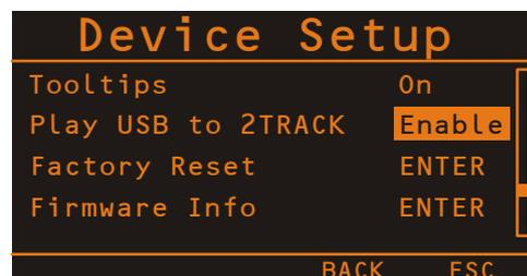
**HINWEIS:** Beachten Sie, dass der 2TRACK IN-Level unabhängig von der Stellung des Faders im USB 1-2 Kanal ist.
