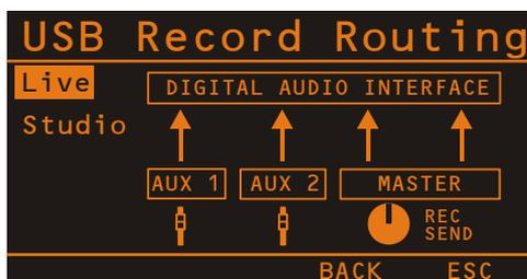
Durch Drehen des MENU/ENTER-Drehencoders kann die Zuordnung von Bussen des PowerMate zu den vier Kanälen USB 1 bis 4 gewählt werden. Es steht eine Zuordnung für den Live-Betrieb und eine Zuordnung für den Studio-Betrieb zur Verfügung, siehe folgende Tabelle. Drücken des MENU/ENTER-Drehencoders übernimmt die gewählte Zuordnung. Drücken der BACK-Funktionstaste führt in das Menü zurück. Drücken der ESC-Funktionstaste führt in die Effekt-Betriebsart zurück.
