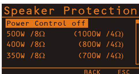
Im Speaker Protection Dialog kann durch Drehen des MENU/ENTER-Drehencoders die RMS-Nennleistung des Lautsprechers eingestellt werden. In jeder Zeile ist links die Leistung für einen 8 Ohm Lautsprecher angegeben. Dieser Wert wird auch in der Effekt-Betriebsart im Display angezeigt. Zusätzlich ist in jeder Zeile rechts die entsprechende Leistung für einen 4 Ohm Lautsprecher angegeben. Zur Deaktivierung der Schutzschaltung wäh-
