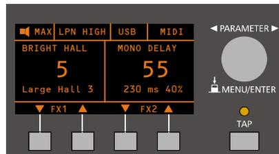
Beachten Sie, dass die Tasten unter dem Display mit anderen Funktionen belegt werden, sobald Sie sich innerhalb der Menüs bewegen. Weitere Informationen entnehmen Sie bitte dem Abschnitt "DISPLAY mit Funktions-Tasten" auf Seite 70.
