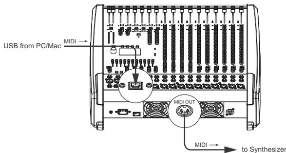
Abbildung 4-5: Übertragung von MIDI-Daten von einem Master Keyboard zum PC/Mac
