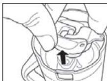
**Remarque:** Pour remonter l'appareil, inversez la procédure ci-dessus et vérifiez que la valve est bien verrouillée en place avant de recommencer à mélanger. La petite flèche sur l'avant de la valve sera alignée avec la petite flèche sur le bas du bol où est affiché le symbole cadenas fermé. Si la valve n'est pas correctement verrouillée en place, le contenu va fuir par le trou de vidange au fond du bol.
