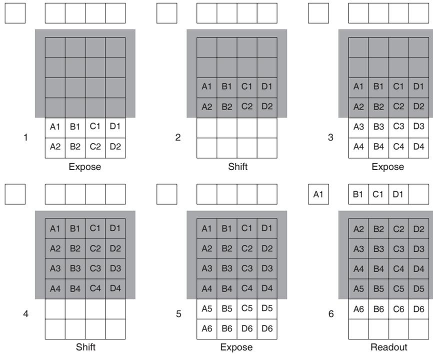
Figure 19. Kinetics Readout
