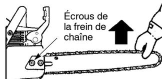
**AVERTISSEMENT:** Si le tronçonneuse est fonctionné avec une chaîne lâche, la chaîne pourrait saut de la barre et du résultat dans les blessures graves.
