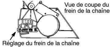
4. À la main, tournez la vis de réglage dans le sens inverse des aiguilles d'une montre pour déplacer le pivot de réglage le plus loin possible vers l'arrière. Cela devrait permettre au pivot d'être dans la bonne position. Un réglage ultérieur peut s'avérer nécessaire lors du montage de la barre.
