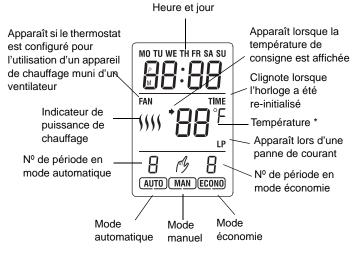
\* Le thermostat affiche normalement la température réelle (mesurée). Pour voir la température de consigne (réglée), appuyer une fois sur l'un des boutons  $\bigcirc$   $\bigcirc$ .
