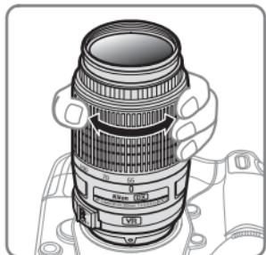
Prima di mettere a fuoco, ruotare l'anello zoom per regolare la lunghezza focale e inquadrare la fotografia. Se la fotocamera è dotata di anteprima di profondità di campo (stop down), è possibile visualizzare l'anteprima di profondità di campo nel mirino.
