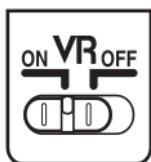
**ON**：シャッターボタンを半押しすると、手ブレを補正します。ファインダー像のブレも補正するため、ピント合わせが容易で、フレミングしやすくなります。
