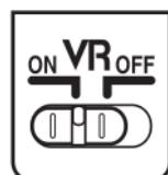
**Seleccione ON para activar la reducción de la vibración.**
