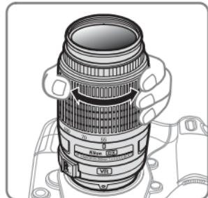
Avant de faire la mise au point, tournez la bague de zoom pour régler la focale et cadrer la photographie. Si l'appareil photo offre un aperçu de la profondeur de champ (fermeture du diaphragme), il est possible d'avoir un aperçu de la profondeur de champ dans le viseur.
