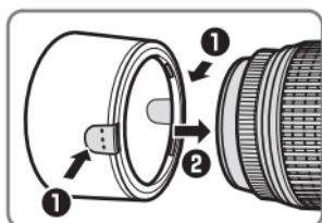
V případě, že není sluneční clona používána, lze ji otočit a nasadit na objektiv v obrácené poloze.
