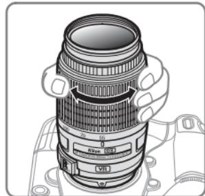
Drehen Sie, bevor Sie fokussieren, den Zoomring, um die Brennweite einzustellen und einen Bildausschnitt zu wählen. Verfügt die Kamera über eine Abblendtaste, kann die Tiefenschärfe im Sucher im Voraus bewertet werden.
