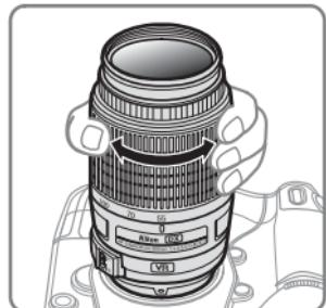
对焦之前，请旋转变焦环调整焦距并进行构图。若照相机支持景深预览（光圈缩小），则景深可在取景器中进行预览。
