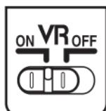
**Vyberte ON na aktiváciu stabilizácie obrazu.** Ak je tlačidlo spúšťe stlačené do polovice, aktivuje sa stabilizácia obrazu, čím sa redukujú účinky chvenia fotoaparátu a zlepšuje sa zaostrovanie.
