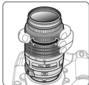
Draai aan de zoomring voordat u scherpstelt om de brandpuntsafstand aan te passen en de foto te kadreren. Als de camera over voorbeeld scherptediepte beschikt (stop omlaag), kan scherptediepte ook als voorbeeld in de zoeker worden bekeken.
