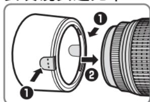
不使用时，可将遮光罩反转并固定在镜头上。
