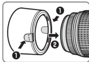
Le parasoleil peut être retourné et monté sur l'objectif lorsqu'il n'est pas utilisé.
