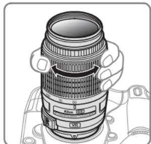
Před zaostřením otočte zoomovým kroužkem, upravte ohniskovou vzdálenost a zkomponujte snímek. Pokud fotoaparát nabízí kontrolu hloubky ostrosti (zavření clony na pracovní hodnotu), hloubku ostrosti lze zkontrolovat v hledáčku.
