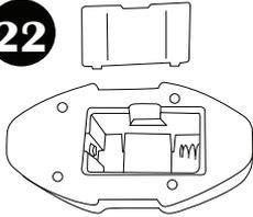
Ouvrir le compartiment de la pile de l'appareil en insérant un tournevis dans la fente. Insérer une pile D « LR20 » (non comprise).
