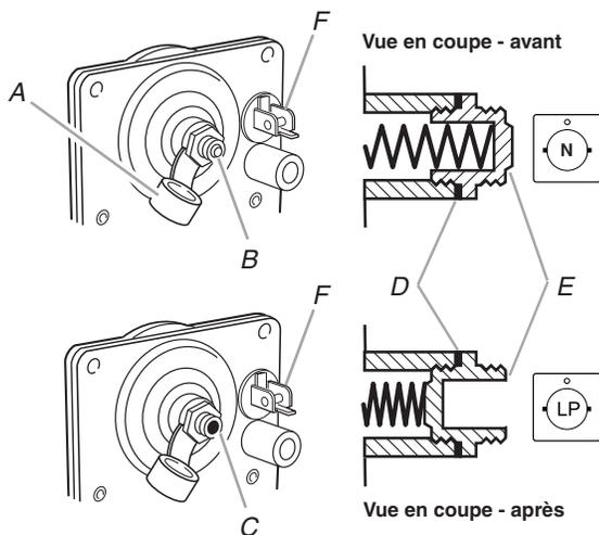
6. Inverser la position du capuchon du détendeur avant de le réinstaller sur le détendeur; l'extrémité ouverte doit être orientée vers l'extérieur, et les lettres "LP" doivent être visibles.
