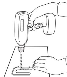
Pour monter la bride antibasculement sur un plancher en béton ou en céramique, utiliser un foret à maçonnerie de  $\frac{3}{16}$ " (4,8 mm) pour percer 2 trous aux emplacements indiqués sur le gabarit de la bride. Enlever le gabarit du sol. Enfoncer les ancrages en plastique dans les trous à l'aide d'un marteau.
