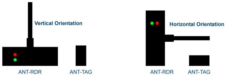
FIG. 5 ANT-RDR / ANT-TAG Antenna Orientation
