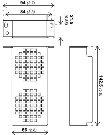
**Assembled MicroFlex e100 and fan tray**
