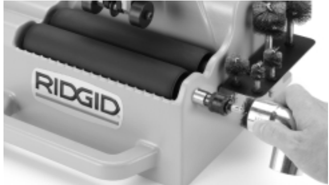
Figura 9 – Limpieza del interior de un fitting
