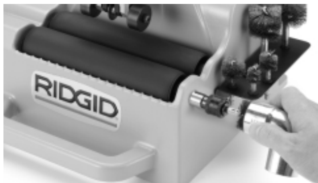
Figure 9 – Nettoyage de l'intérieur des raccords
