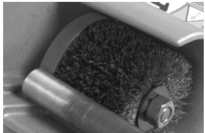
Figura 7 – Eliminación de las rebabas externas del tubo
