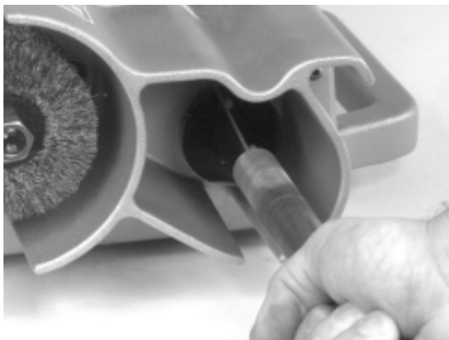
Figure 8 – Alésage de l'intérieur du tuyau
