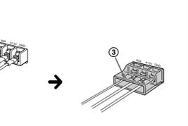
Faites passer les fils par le cache, raccordez les fils, puis recouvrez les bornes avec le cache.
