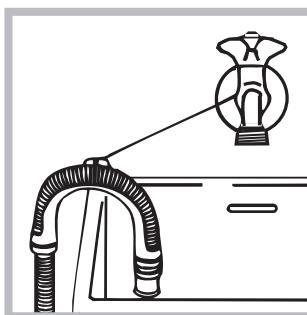
af of hang hem aan de rand van een wasbak of badkuip, en bind de bijgeleverde steun aan de kraan (zie afbeelding). Het uiteinde van de afvoerslang mag niet onder water hangen.
