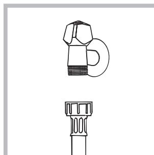
1. Sluit de tovoerbuis aan op de koudwaterkraan met een mondstuk met schroefdraad van  $3/4$  gas (zie afbeelding).
