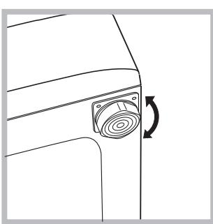
2. Se o pavimento não for perfeitamente horizontal, para compensar qualquer irregularidade, des-tarraxe ou atarraxe os pés dianteiros (veja a figura); o ângulo de inclinação, medido no plano de trabalho, não deve ultrapassar 2°.
