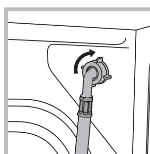
1. Realize a ligação do tubo de alimentação parafusando-o a uma torneira de água fria com bocal de rosca de 3/4 gás (veja a figura). Antes de realizar esta ligação, deixe a água escorrer até estar limpida.
