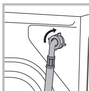
2. Conecte el tubo de alimentación a la lavadora enroscándolo en la toma de agua correspondiente ubicada en la parte posterior derecha (arriba) (*ver la figura*).
