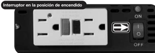
El inversor está ahora listo para suministrar alimentación de CA a sus cargas. Si va a hacer funcionar varias cargas, enciéndalas una por una después de haber encendido el inversor. De esta manera el inversor no tendrá que suministrar simultáneamente las corrientes de arranque requeridas por las distintas cargas.
