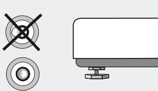
Coloque la plataforma de pesaje en el lugar de trabajo. Utilice el nivel y las patas regulables para asegurarse que la báscula está en posición horizontal.
