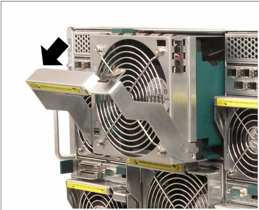
Figure 98: Removing the fan unit
