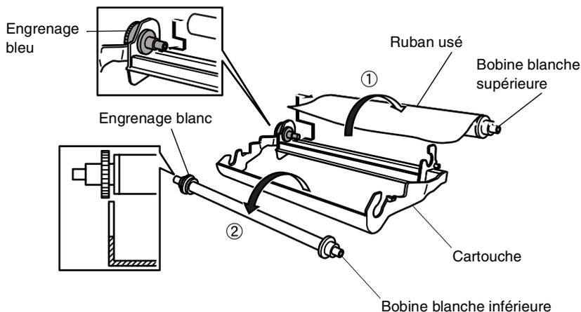
4 En faisant coulisser, retirez l'élastique blanc des nouveaux rouleaux de remplissage et placez avec le rouleau entier en position inférieure. (La partie brillante du ruban est dirigée vers le *bas*.)
