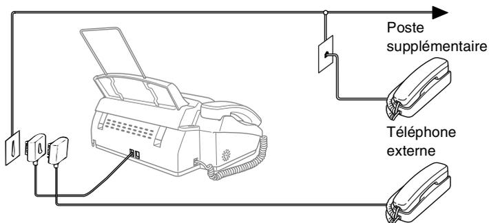
Lorsque ce téléphone externe (ou REP) est utilisé, l'écran affiche **TEL . EXT . OCCUPE** (pour FAX-T94/T96) ou **TELEPHONE** (pour FAX-T92), et, si le combiné du télécopieur est décroché, une alarme sonne.
