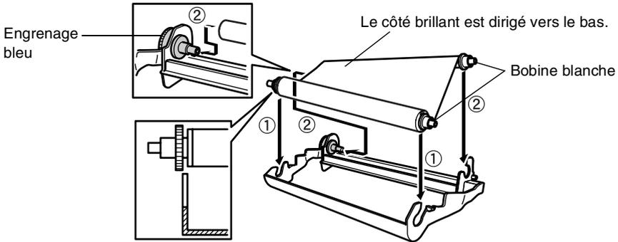
**7** Tournez la bobine blanche supérieure droite *dans le sens des aiguilles d'une montre* pour tendre le ruban, voir illustration.
