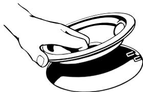
2. Tenir l'élément en spirale le plus possible de niveau et pousser doucement la fiche de l'élément en spirale dans la prise.
