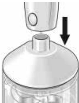
6. Conecte la unidad motriz con el electrodoméstico y presiónelo firmemente mientras corta el alimento.
