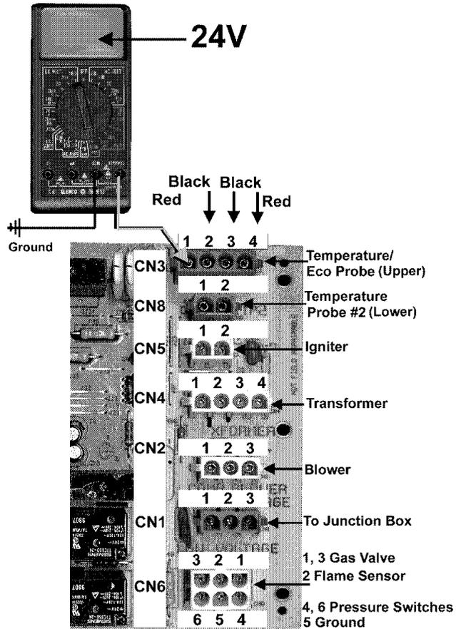
**STEP 5:** CHECK FOR 24 VAC BETWEEN PIN 1 ON CN3 PLUG AND GROUND.
