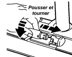
Insérez l'ampoule, poussez dessus puis faites-la tourner dans le sens horaire.
