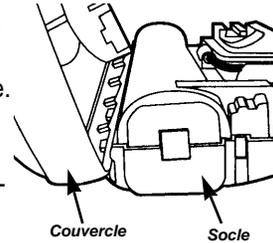
7. Rabaissez le couvercle et appuyez fermement dessus jusqu'à ce que les agrafes latérales arrière s'encliquent. Tournez le balai motorisé à l'envers et remettez en place les deux vis du couvercle.
