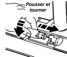
Poussez sur l'ampoule et faites-la tourner dans le sens anti-horaire, puis tirez dessus pour l'enlever.
