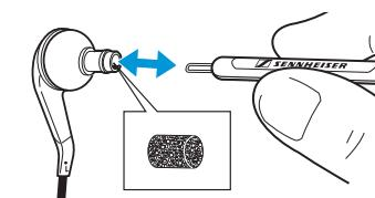
► Wechseln Sie verschmutzte Membranschutz-Stifte mit dem Reinigungswerkzeug oder einer Pinzette.
