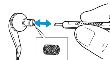
► Cambie las clavijas de protección de membranas sucias con la herramienta de limpieza o con una pinza.
