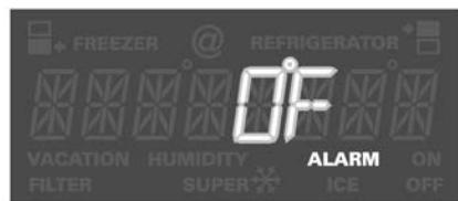
Une alarme de température se signale par le clignotement de la température requise et l'allumage du symbole ALARM. Un signal retentit également si vous avez activé la fonction SIGNAL SONORE dans le mode Configuration.
