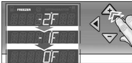
La temperatura puede cambiarse hacia valores mayores mediante el pulsador + (más caliente) o - (más frío). La temperatura puede ajustarse en pasos de 1 °F (0,5 °C).
