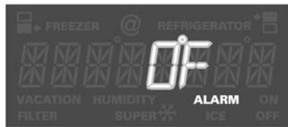
Se indica una alarma respecto de la temperatura a través de una visualización intermitente de la misma y el encendido de la señal de ALARM(a). También suena un sonido de alarma, siempre que esté activado este método en el modo de setup.
