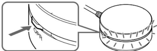
Le témoin DEL de statut se met à clignoter très rapidement et l'appareil passe en mode de pairage.
