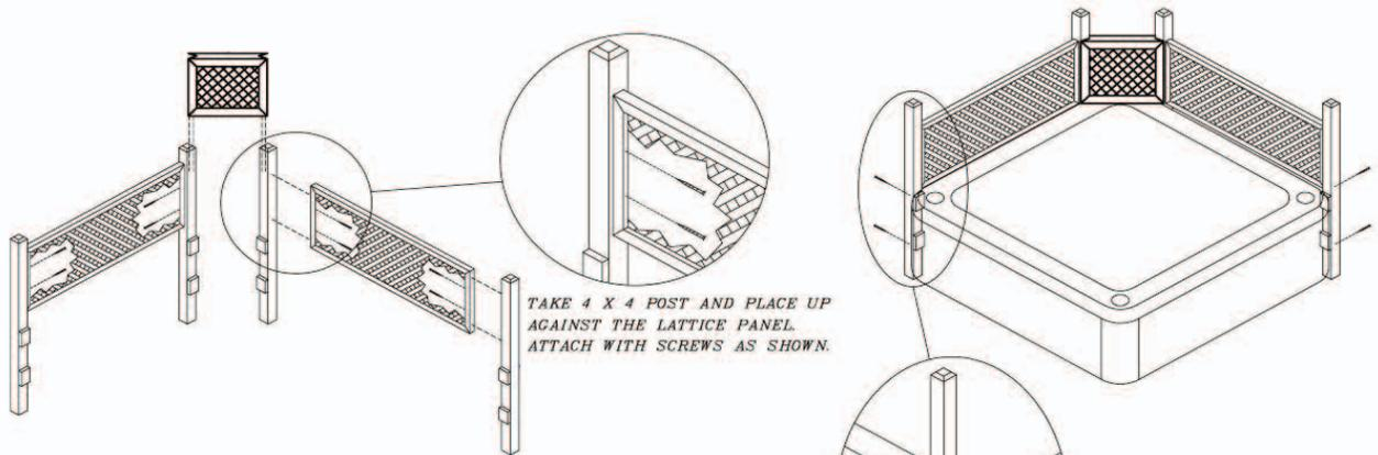
TAKE 4 X 4 POST AND PLACE UP AGAINST THE LATTICE PANEL. ATTACH WITH SCREWS AS SHOWN.
