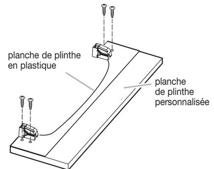
4. Ouvrir partiellement le tiroir inférieur. Positionner la planche de plinthe personnalisée derrière la porte, faire glisser sur la face inférieure de la cuve.
