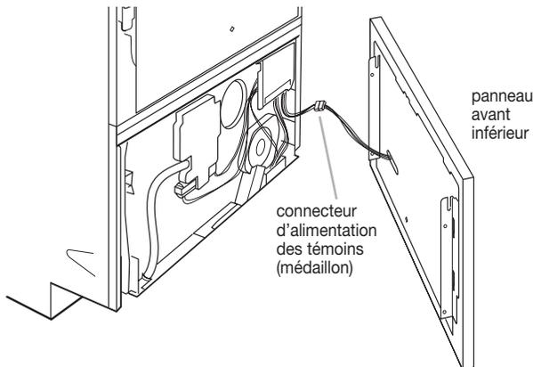
14. Aligner les crochets de la plaque métallique avec les encoches et fentes du lave-vaisselle; tirer doucement vers le haut pour réaliser le blocage.
