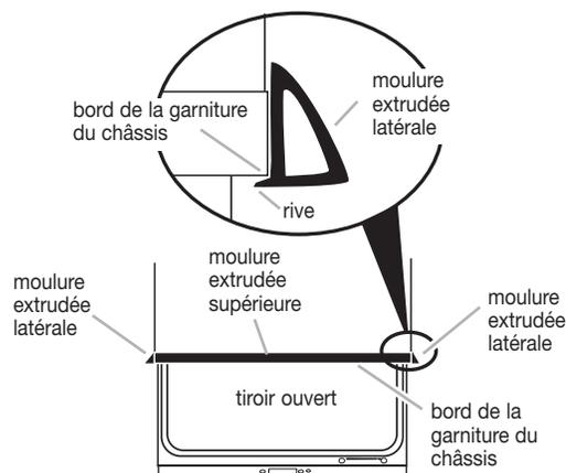
5. Placer les moulures extrudées sur la garniture, et appuyer.
