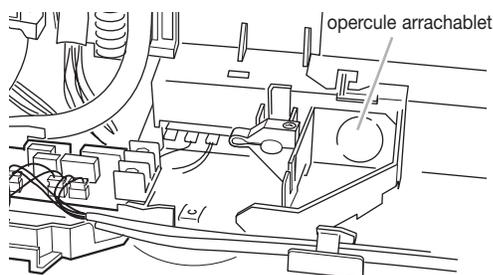
7. Faire passer les conducteurs du câblage de la maison à travers le connecteur de conduit (non fourni), et dans le lave-vaisselle (à travers l'ouverture de l'opercule arrachable).
