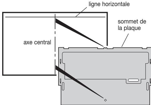
12. À l'aide des vis fournies, fixer la plaque métallique au panneau avant à travers les trois trous internes.
