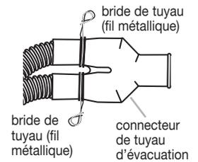
**NOTE :** La connexion du tuyau d'évacuation ne doit pas soutenir le poids d'un excès de longueur du tuyau. Veiller à ce que chaque segment de tuyau soit aussi étiré que possible.
