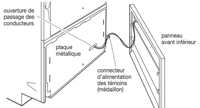
4. Faire passer doucement les connecteurs et conducteurs à travers l'ouverture de la plaque métallique.
