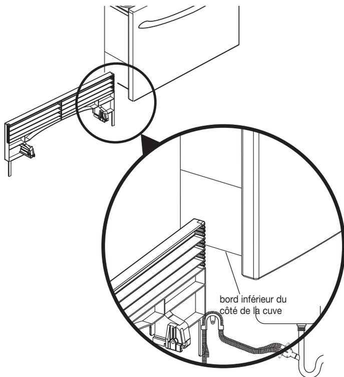
4. Sur une surface stable, placer la planche de plinthe sur une planche à découper en bois et choisir la rainure la plus proche du repère. Si le repère se trouve entre deux rainures, choisir celle qui permet d'obtenir la planche de plinthe la plus courte.
