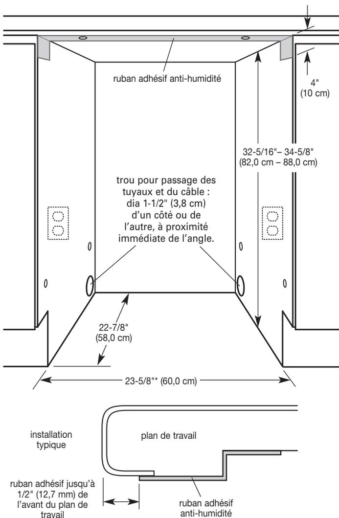
La prise à 3 alvéoles de liaison à la terre doit être installée à une distance de 6" (15,2 cm) à 18" (45,7 cm) de la paroi latérale du placard.
