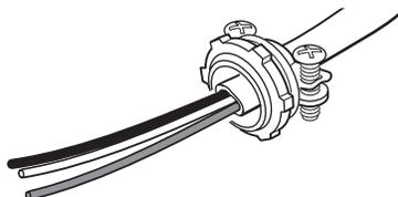
8. Fixer solidement le connecteur de conduit dans l'ouverture de l'opercule arrachable.
