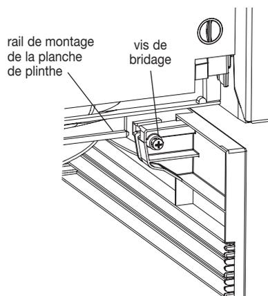
9. Fermer le tiroir. Vérifier qu'il y a un espace libre de 1/2" (12,7 mm) ou plus entre le bord inférieur de la planche de plinthe et le plancher.
