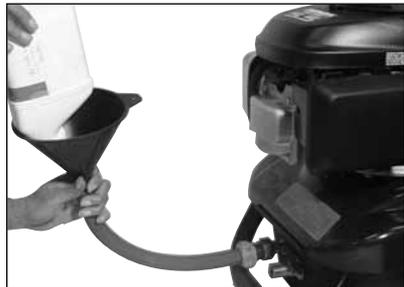
6. Tirez à plusieurs reprises sur le cordon de démarrage du moteur, jusqu'à ce que l'antigel ou le liquide de lave-glace déborde du raccord du boyau à haute pression de la pompe.
