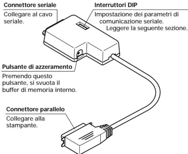
Oltre al convertitore, vi occorrerà anche un cavo seriale appropriato. Rivolgetevi al rivenditore presso cui avete acquistato la stampante se non siete sicuri sul tipo di cavo seriale da usare per il vostro sistema.
