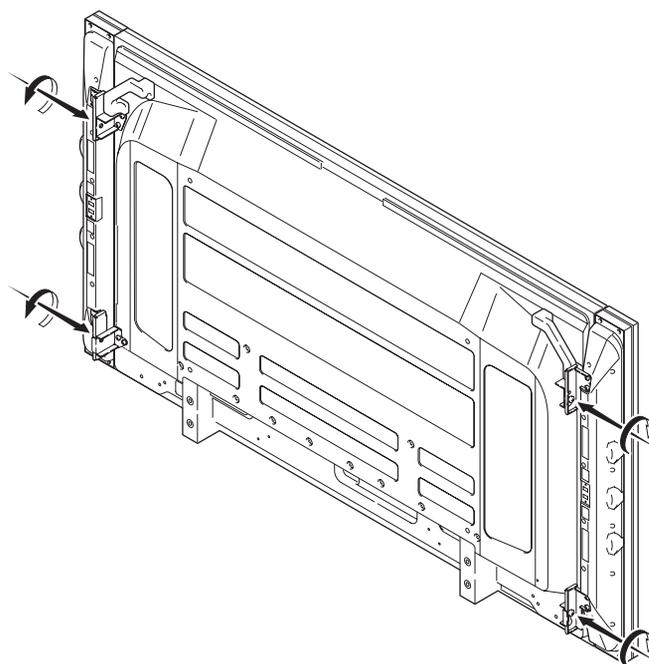
**4 Fissare le viti (M5), già serrate in posizione ai ganci sulla parte superiore degli altoparlanti. Serrate bene le viti (M5) nei fori sulla parte inferiore degli agganci, allineati con quelli dei ganci sulla parte inferiore degli altoparlanti.**
