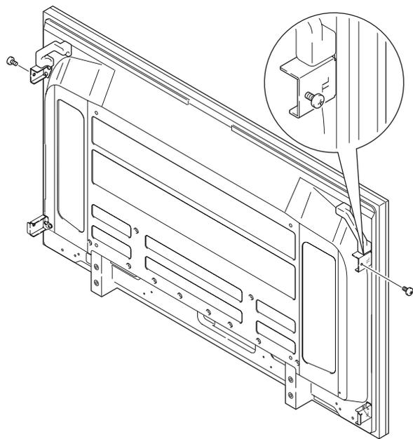
**4 Fixez les vis (M5) qui ont été légèrement vissées sur les crochets situés en haut des enceintes. Superposez les trous situés sur les pièces de fixation du bas avec les trous situés en bas des enceintes, et vissez légèrement les vis (M5) dans ces trous.**
