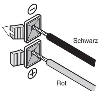
Drücken Sie die Taste der Lautsprecherbuchse und halten Sie sie gedrückt, während Sie den Draht des Lautsprecherkabels einföhren. Geben sie anschließend die Taste wieder frei.
