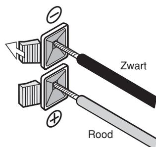
Druk op het lipje van de stekerbuis van de speaker en houd dit ingedrukt om de draad van het speakersnoer in te steken; laat vervolgens het lipje los.
