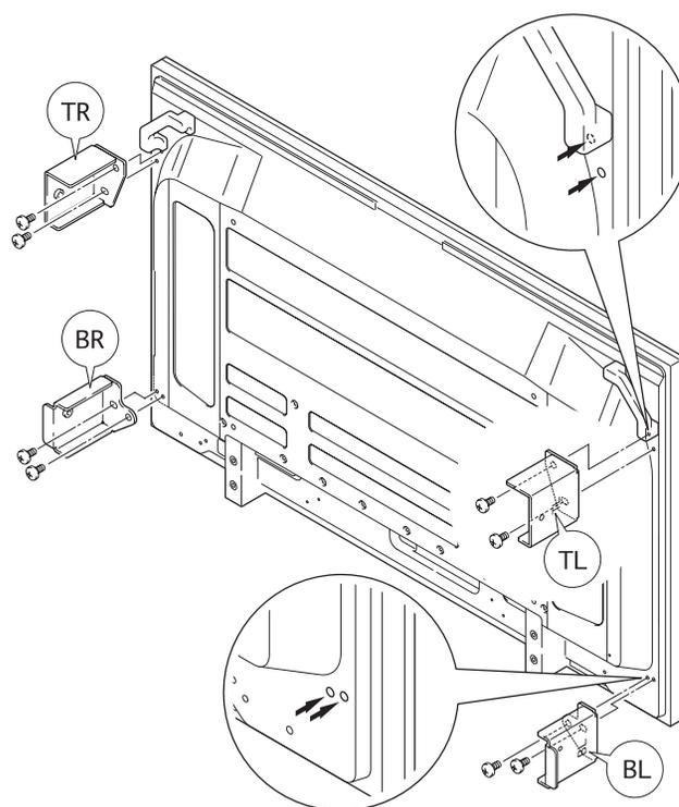
**3 Vissez légèrement les vis (M5) sur les pièces de fixation du haut (2 endroits).**
