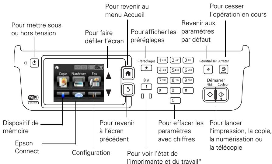
\* Le témoin orange (à gauche) s'allume lorsque le niveau d'encre d'une cartouche est bas. Il clignote lorsqu'une erreur se produit ou lorsqu'une cartouche est épuisée. Le témoin bleu (à droite) s'allume lorsqu'il y a des travaux d'impression en attente et il clignote lorsque le produit traite des données.
