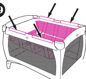
**VÉRIFIEZ:** Les deux tubes **DOIVENT** être installés avant de placer le matelas dans la couchette.
