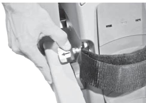
3. Abbassare cautamente il telaio anteriore tra le guide e bloccarlo con il fermo sull'estremità anteriore della sella. Verificare che il telaio anteriore sia bloccato.
