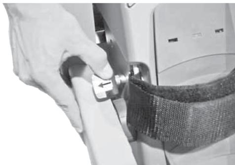
3. Klappen Sie den Vorderrahmen vorsichtig zwischen den Schienen zusammen und verriegeln Sie ihn mit der sich im vorderen Ende des Sitzes befindlichen Halterung. Vergewissern Sie sich, dass der Vorderrahmen sicher befestigt ist.
