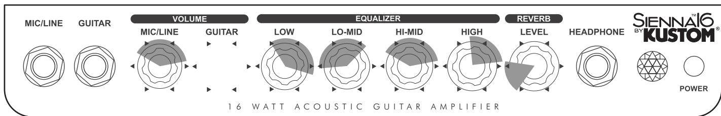
Réglage standard pour une guitare - Dans ce cas de figure votre instrument est connecté dans l'entrée 1 (mic/line). N'oubliez pas que si vous utilisez une guitare préamplifiée, il faut d'abord régler le volume du préampli de la guitare à la moitié de son rendement sous peine de saturation ou de larsen. Ce réglage donne un son clair et propre auquel on peut ajouter des graves afin d'augmenter la «présence». Ajustez la réverbé selon votre oreille.
