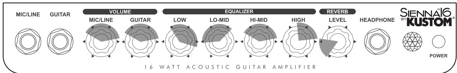
Ajustes estándar para la utilización de dos entradas - En este ajuste se utilizan las dos entradas. La guitarra se enchufa a la entrada de guitarra, y un micrófono a la entrada de alta impedancia. Suba el volumen del amplificador lentamente para evitar acoples. Haga un balance entre las dos entradas lo que le dará un sonido de guitarra acústica mas natural. Naturalmente usted puede enchufar cualquier combinación de instrumentos como: teclados, micrófonos u otras guitarras.
