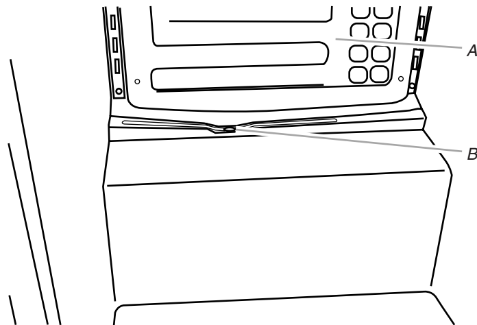
A. Placa de evaporación B. Tubo de desagüe
