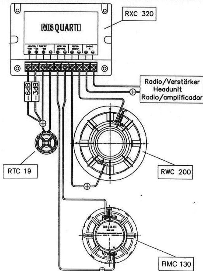
Nach Feststellung der korrekten Funktion können Sie bei abgeschalteter Anlage die Polung beider Hochtöner einmal ändern (PLUS und MINUS vertauschen). Dies kann je nach Einbausituation zu einer besseren räumlichen Abbildung führen. Zusätzlich können Sie einen evtl. zu lauten Hochtöntonpegel in 2 Stufen (-3dB, -6dB) durch Umklemmen an der Frequenzweiche absenken (s. Abbildung).
