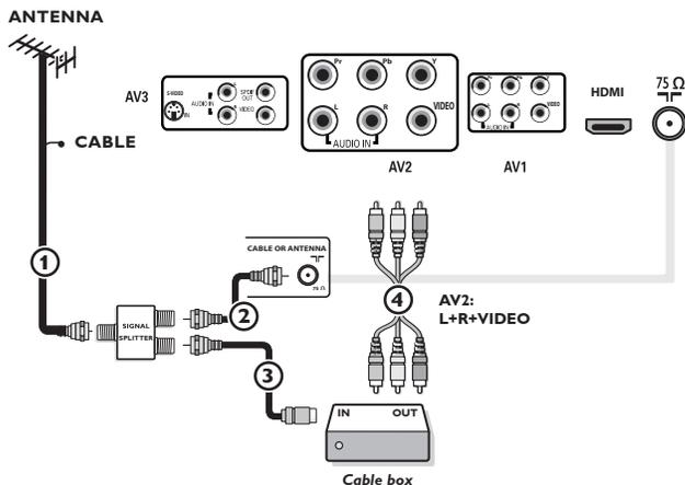
*Note : L'entrée du signal vidéo d'entrée peut être gérée par AV1 et AV3 également.*
