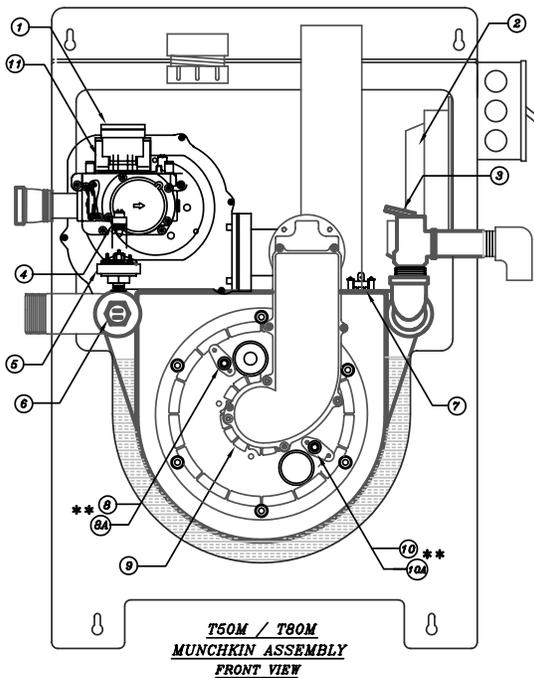
\*\* THE LOCATION OF THE HOT SURFACE IGNITOR AND FLAME RECTIFICATION PROBE IS REVERSED FOR ALL HA MODELS
