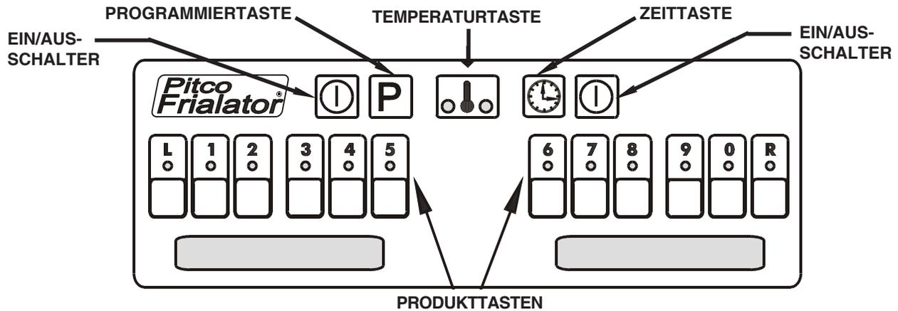
ÜBERPRÜFEN DER \_\_\_\_\_ TATSÄCHLICHEN TEMPERATUR drücken. Nach 5 Sekunden kehrt die Maschine in den Betriebsmodus zurück.
