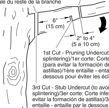
Figure 11 - Cutting A Limb Figura 11 - Poda de una rama Figure 11 - Coupe d'une branche
