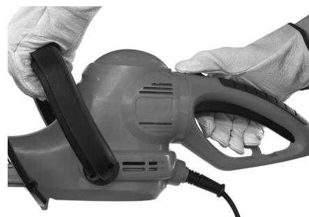
Figura 3-8: Suelte el interruptor del gatillo para parar la podadora
