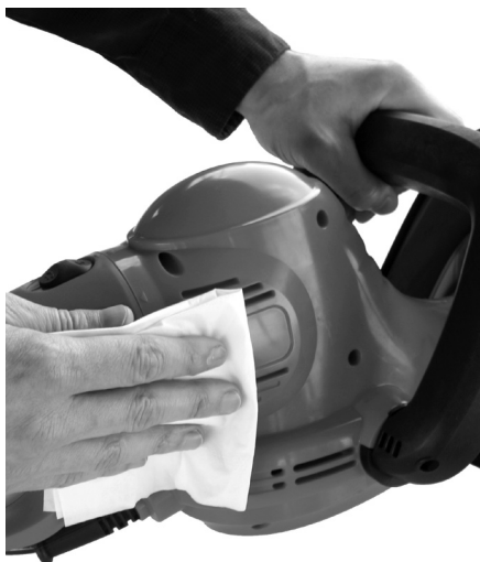
Figure 4-1 : Nettoyage du boîtier du taille-haie
