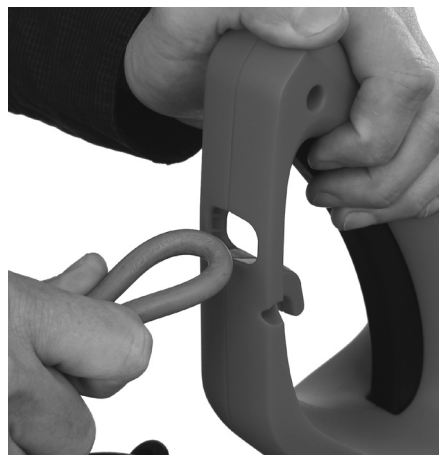
Figura 3-2: Inserción del bucle del cordón de extensión por la parte inferior del asa
