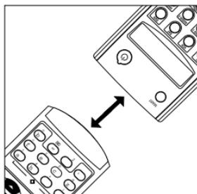
Plaats de bovenkant van uw oude afstandsbediening recht tegenover de infraroodsensor van de SBC RU880. Leg beide afstandsbedieningen op een vlakke ondergrond en 3 tot 8 centimeter van elkaar. Zorg ervoor dat in beide afstandsbedieningen nieuwe batterijen zitten.
