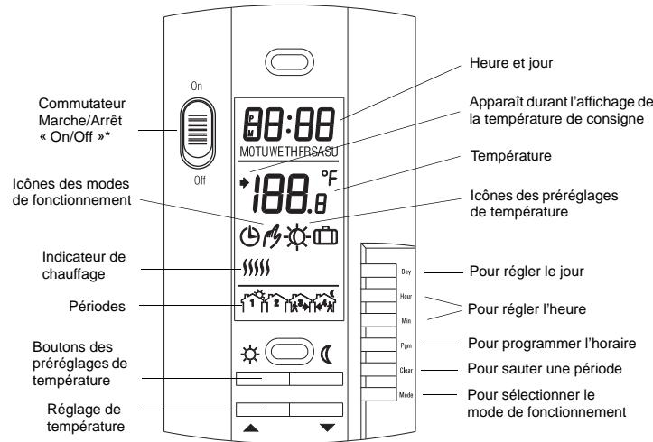
\* Positionner le commutateur à « Off » pour couper l'alimentation de l'appareil de chauffage. Cela n'affectera pas les réglages d'heure et de température.
